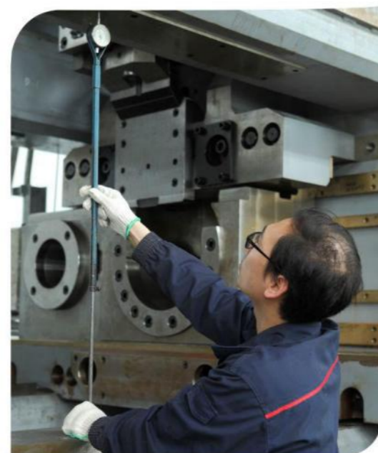
主机装配精度检测
